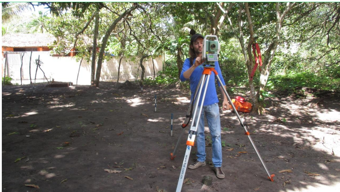
Figura 24: início da topografia com a Estação total para o setoriamento e planta altimetria do sítio
